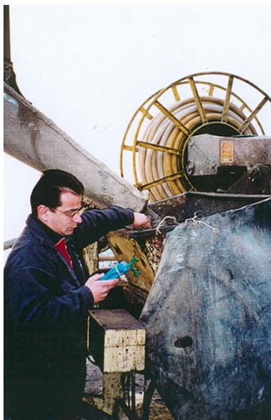
(α) Μέτρηση στο σκυρόδεμα (β) Διάταξη θερμοστατών στη βάση του δοχείου του επιταχυντή Σχήμα 3-9. Μετρήσεις θερμοκρασίας προ της εισόδου του επιταχυντή (Μιχαηλίδης & Γαρατζιώτης, 2009)
