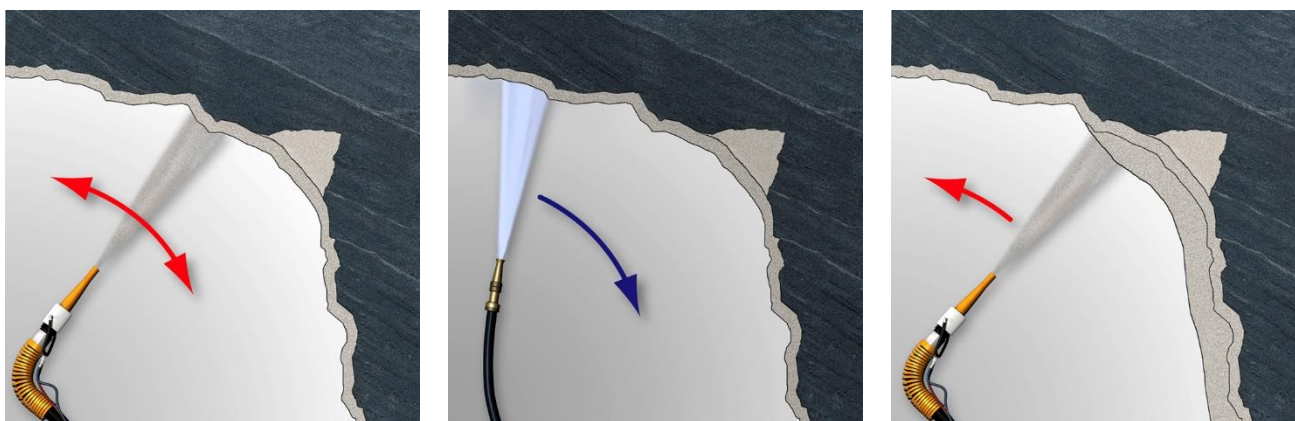
α. 1η στρώση σκυροδέματος για σταθεροποίηση μετά από το γέμισμα διακοπές ψεκασμού υπερεκσκαφών. (β) Καθαρισμός από τη σκόνη μετά από διακοπές ψεκασμού (Χορήγηση από © Sika Hellas ABEE). γ. 2η στρώση σκυροδέματος για σταθεροποίηση αφού απομακρυνθεί η σκόνη με νερό, μετά από διακοπή.
