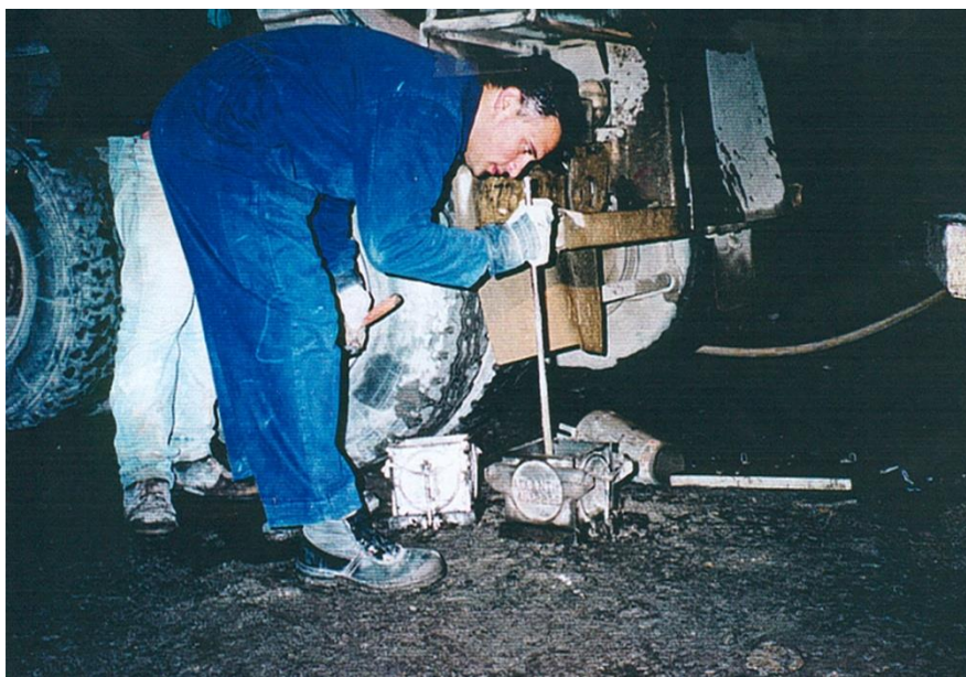
(α) Συμπύκνωση κυβικών δοκιμών σκυροδέματος ακμής 15cm Σχήμα 3-8. Πριν την εισαγωγή του επιταχυντή (Μιχαηλίδης & Γαρατζιώτης, 2009)
