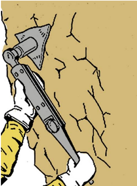
(α) Τάνυση με ροπόκλειδο Σχήμα 1-5. Τάνυση ήλων.
