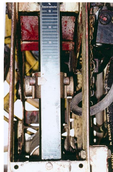
(α) Μέτρηση διαστάσεων δοχείου επιταχυντή (β) Ένδειξη δοσομετρητή Σχήμα 3-10. Επιταχυντικό πρόσμικτο (Μιχαηλίδης & Γαρατζιώτης, 2009)
