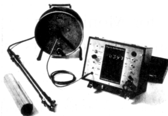
Σχήμα 14. Τυπικός εξοπλισμός αποκλισιομέτρου βολίδας, που δείχνει τον καθοδηγητικό σωλήνα, την βολίδα, το καλώδιο και τη συσκευή ανάγνωσης των μετρήσεων.
