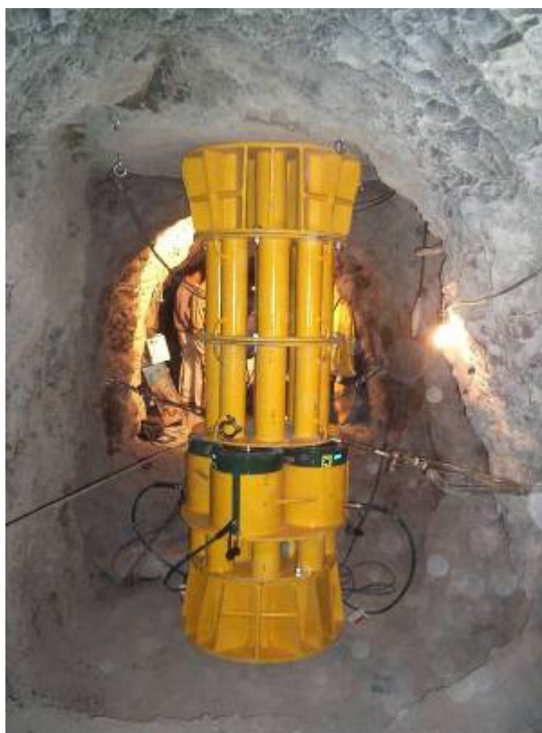
Σχήμα 1. Δοκιμή φόρτισης πλάκας (φωτογραφία της Sabir Co)
